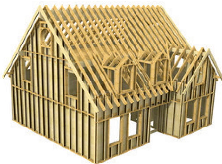
pav. 1: Medinės karkasinės-rėminės konstrukcijos pavyzdys (šaltinis: Holzbau Henz GmbH)
