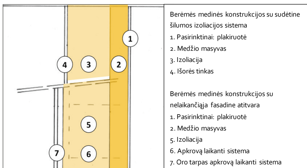
pav. 11: Išorinės berėmės medinės konstrukcijos sienos schema; viršuje sudėtinė šilumos izoliacinė sistema tinko paviršiumi; toliau – nelaikančiosios fasadinės atitvaros variantas (šaltinis: Schulze Darup)
