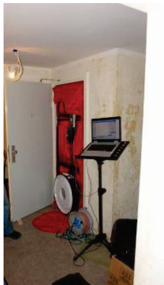
Figura 22: blower door test (fonte: Schulze Darup)
