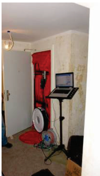
Ilustracja 22: Blower doortest (źródło: Schulze Darup)
