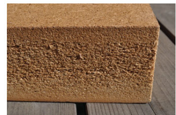
pav. 25: Medienos pluošto izoliacinė plokštė (šaltinis: GrAT)
