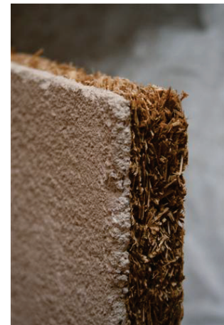
pav. 22: Kalkių tinku padengta nendrių plokštė (kairėje) nendrių granuliu plokštė (dešinėje) (šaltinis: GrAT)
