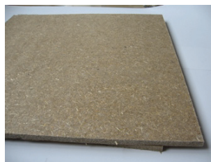
pav. 24: Medienos pluošto izoliacinė plokštė (šaltinis: GrAT)
