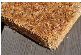
pav. 23: Medienos skiedrų izoliacinė plokštė (šaltinis: GrAT)
