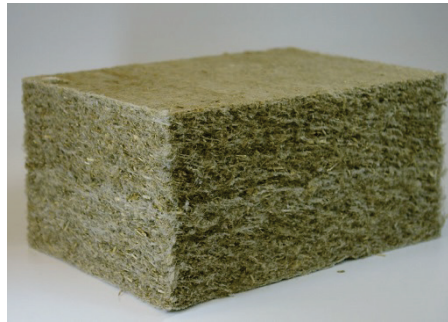
pav. 5: Kanapių pagrindo šiltinimo medžiaga (šaltinis: Christian Gahle, nova-Institut GmbH; http://de.wikipedia.org/wiki/D%C3%A4mmstoff#/media/File:Hanfdaemmstoff_CG.jpg )
