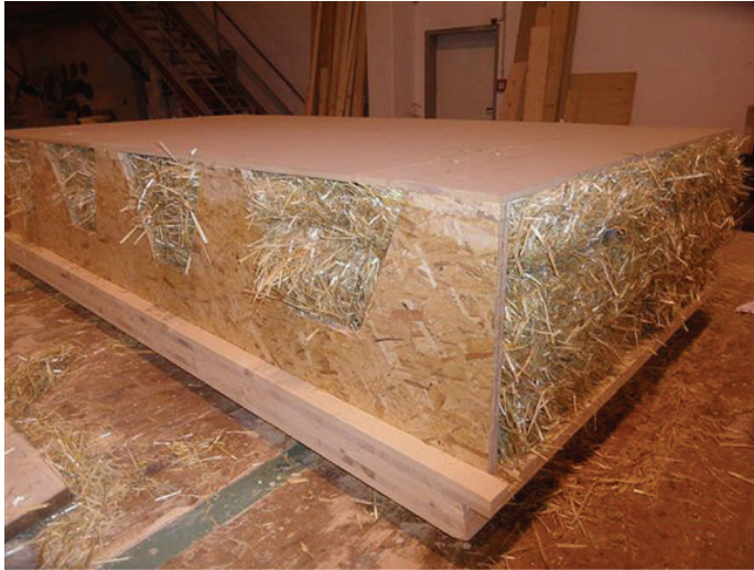
Obr. 15: Prototyp prefabrikovaného stěnového prvku izolací z lisované slámy (zdroj: GrAT)
