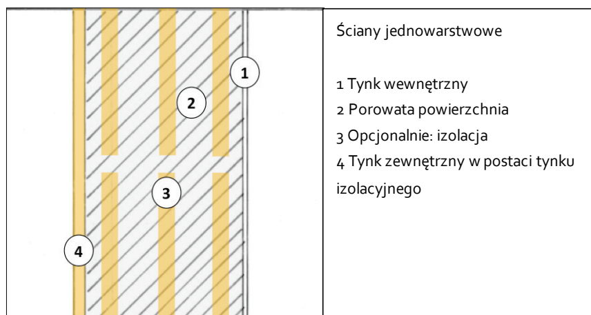
Ilustracja 14: Diagram przedstawia ścianę jednowarstwową budynku pasywnego; otwory/ubytki wypełnione są materiałem izolacyjnym; około 4 cm tynku izolacyjnego położonego jest po zewnętrznej stronie ściany (źródło: Schulze Darup)
