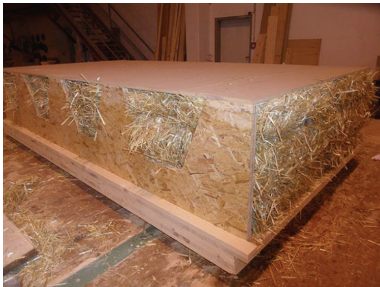
Ilustracja 16: Prototyp prefabrykowanego elementu ściany z izolacją wykonaną ze słomy (źródło: GrAT)
