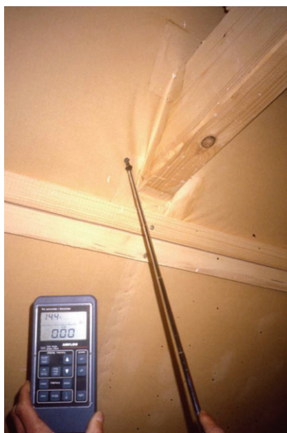
Ilustracja 9: Pomiarnieszczelności dachu (źródło: Schulze Darup)
