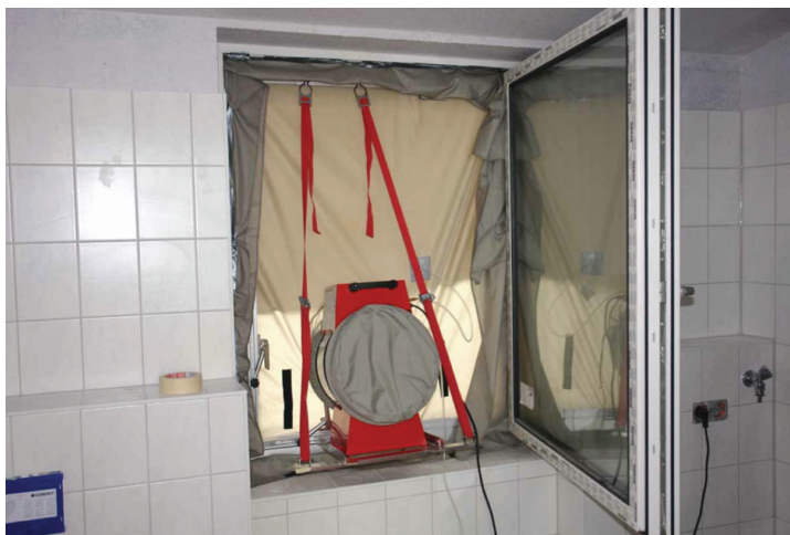
Figura 21: blowerdoortest: in questo caso il dispositivo è installato in una finestra poiché presso la porta d'ingresso vi era una probabilità molto alta di perdite (fonte: Schulze Darup)
