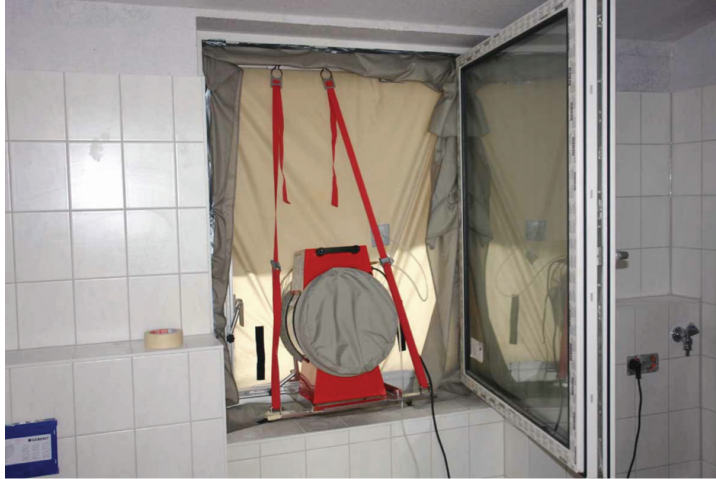
pav. 23: Sandarumo testas: šiuo atveju specialią įrangą įmontuota lange, nes buvo suabejota išorinių durų sandarumu (šaltinis: Schulze Darup).
